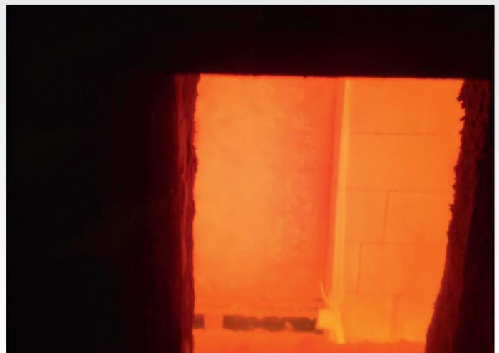
Innenraum eines Gefahrstoffcontainers während des Tests
